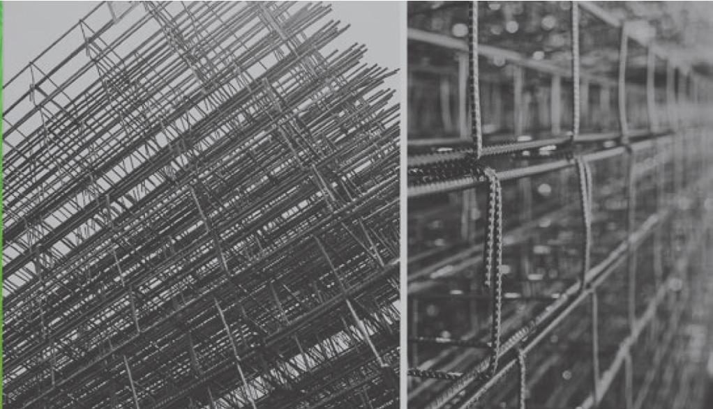
El castillo armacero es una armadura compuesta de alambres longitudinales y transversales unidos por soldadura mediante resistencia. Suele usarse como acero de refuerzo en tráves y columnas.
